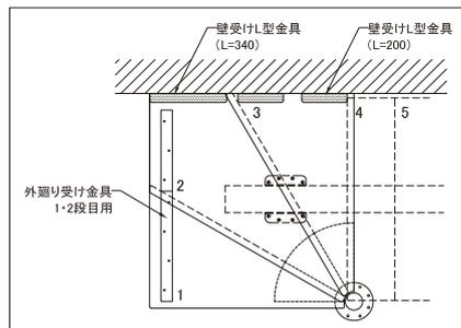
上り口から見て正面に壁面がある場合の納まりです。壁と接する辺は壁受けL型金具を使用します。
