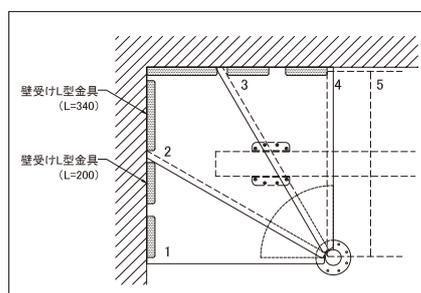
上り口から見て正面と外廻り側に壁面がある場合の納まりです。踏板の外廻り側は壁と固定します。
