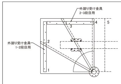
ONE BEAMの両側に壁面が無い場合の納まりです。踏板を自立させて床と固定します。
